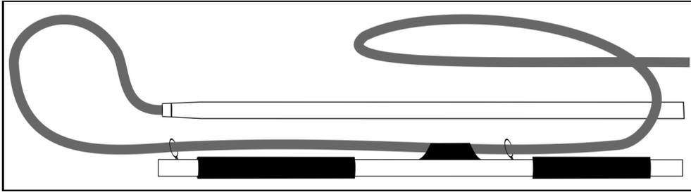
**Figura 8.1.** Modelo de dispositivo de control - pértiga con cuerda que forma un lazo en su extremo anterior
